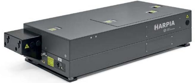
HARPIA-TA 超快瞬态吸收光谱仪的突出性能领先于同行业产品, 如  $0.05 \text{ mOD}$  ( $10^{-4} \Delta T/T$ ) 灵敏度, 以及在搭配 PHAROS / CARBIDE 激光器和 ORPHEUS-OPA 设备一起使用时, 重复频率可达  $1 \text{ MHz}$ 。高重复频率使得单脉冲能量可低至几个 nJ, 从而激发样品并且对瞬态吸收的动力学过程进行精准测量。
