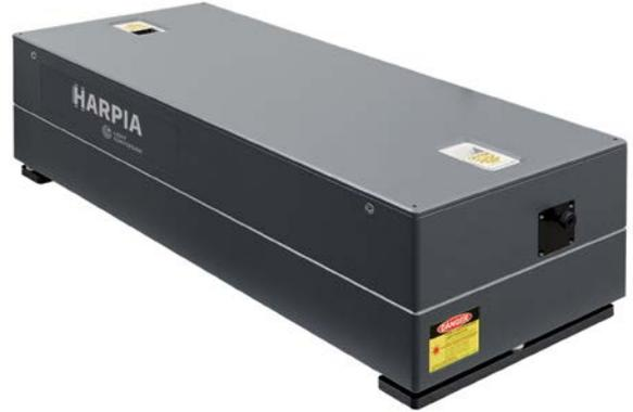
HARPIA-TF 是集合了荧光上转换和 TCSPC 技术的时间分辨荧光测量模块。使用荧光上转换模式时, 样品的信号被混合在一个具有门控飞秒脉冲的非线性晶体中, 以获得高的时间分辨率, 该分辨率受门控脉冲的脉宽限制在 250 fs 内。对于荧光衰减时间超过 150 ps 的, 仪器可采用 TCSPC 模式 (时间相关的单光子计数) 模式, 测量 200 ps – 2 μs 时间范围内的运动轨迹。HARPIA-TF 模块支持 Becker&Hickl TCSPC 设备和探测器。
