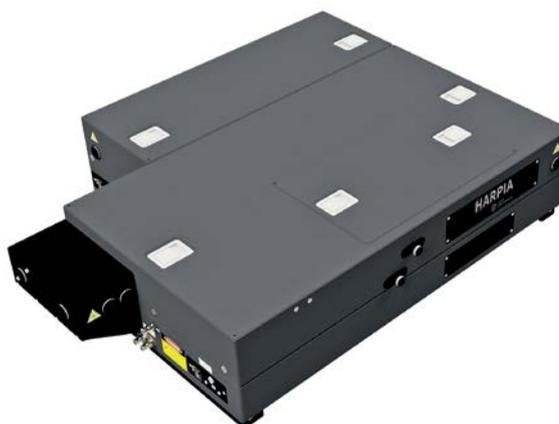
超快多脉冲瞬态吸收, TCSPC 和荧光上转换光谱系统
